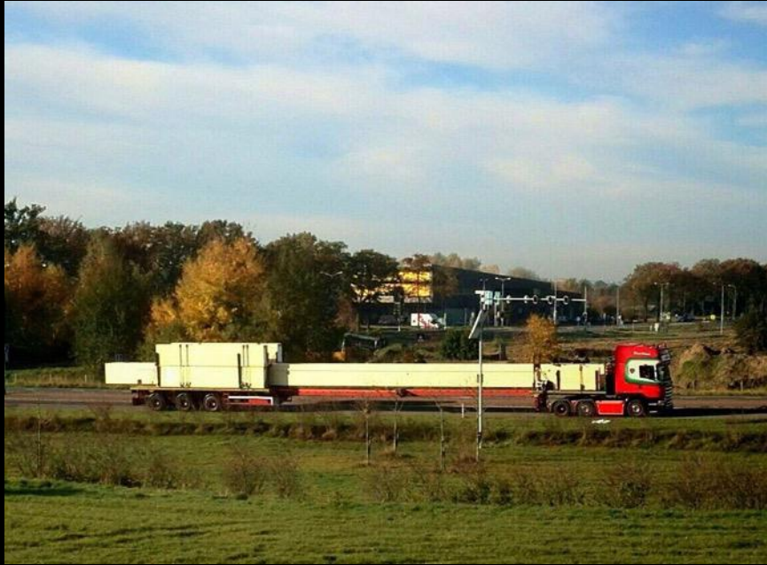
Transport met oplegger van 31 meter lang
